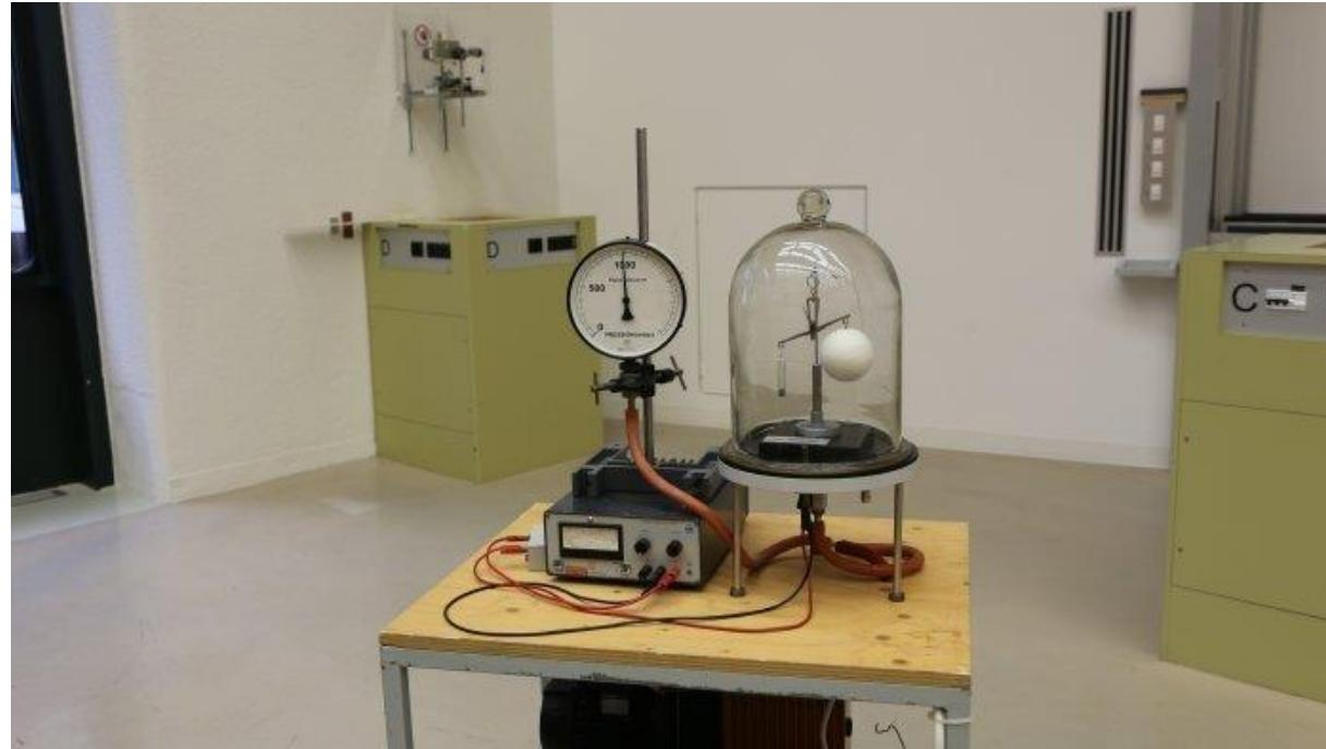
Une masse de plomb de petite taille est relié par un tige à une masse de polystyrène de grande taille: dans l'air le système est à l'équilibre. Que se passe-t-il dans le vide ?
